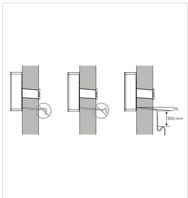
⚠ Le système d'écoulement doit prévoir une siphon adéquat afin de prévenir la pénétration involontaire d'air dans le système de
