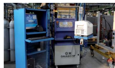
Poste de tests d'étanchéité à l'hélium
